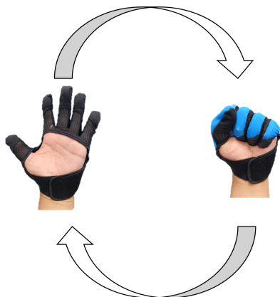
그림 4. 웨어러블 장갑을 착용한 상태에서 주먹을 완전히 쥐었다 완전히 펴는 동작을 반복하며 캘리브레이션을 수행한다 Fig. 4. An example of calibration. While repeating making a hand open and fist, calibration phase was carried on
